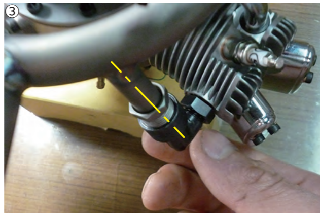
③マフラーナットを全てのアダプターに軽くねじ込みます。3つ全て指で2～3回転くらいはネジに入るように位置を合わせて下さい。ナットをアダプターに対し垂直にそろえる事が肝心です。無理やりにねじ込むと、リングマフラーを破損します。※3つのマフラーナットの位置がうまく合わない場合は、アダプターをそれぞれ入れ替えて下さい。 ③Insert 3 nuts of the ring muffler into each adpoter. Adjust position that all threads can be turned about 2~3 turns by fingers. The key is aligning each nut and adpoter vertically. Never tighten by force otherwise you may break thread. ※If you can't fit the position, replace adpoters each other.
