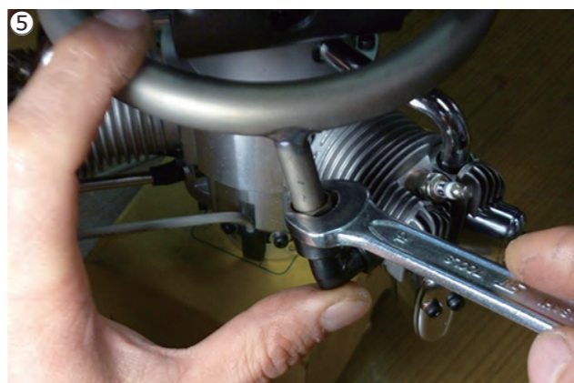
⑤各ナットを指で回せるだけ回してから、スパナで締めこみます。3つを均等に、少しずつ締めこんで下さい。 ⑤Tighten the nuts by fingers until it stops. Then equally tighten up each nut little by little with a spanner.
