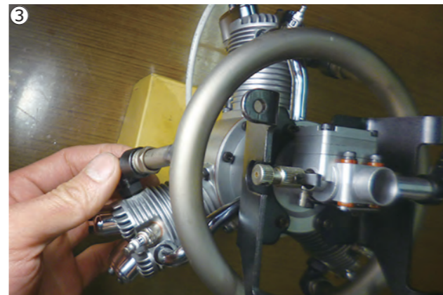
③マフラーナットを全てのアダプターに軽くねじ込みます。3つ全て指で2～3回転くらいはネジに入るように位置を合わせて下さい。ナットをアダプターに対し垂直にそろえる事が肝心です。無理やりにねじ込むと、リングマフラーを破損します。※3つのマフラーナットの位置がうまく合わない場合は、アダプターをそれぞれ入れ替えて下さい。 ③Insert 3 nuts of the ring muffler into each adpoter. Adjust position that all threads can be turned about 2~3 turns by fingers. The key is aligning each nut and adpoter vertically. Never tighten by force otherwise you may break thread. ※If you can't fit the position, replace adpoters each other.
